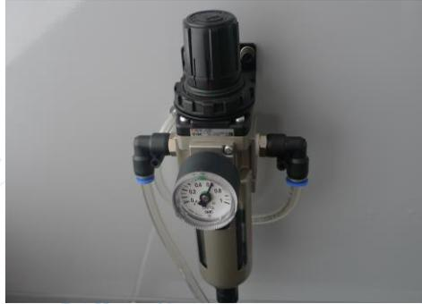
本机必须与空气压缩机配合使用，输入空气压力值最小应设置在 0.45Mpa~0.55Mpa
