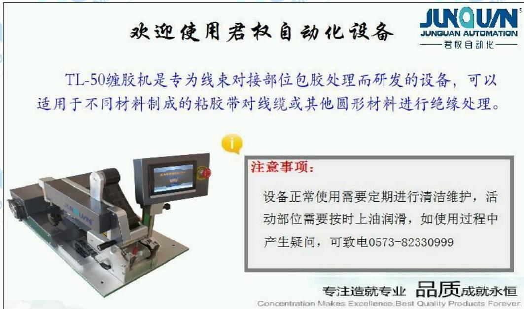
TL-50 缠胶机是专为线束对接部位包胶处理而研发的设备，可以使用于不同材料制成的粘胶带对线缆或其他圆形材料进行绝缘处理。
